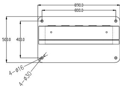
Notare la  $\phi 30$  fori sono per l'accesso, si consiglia di utilizzare bulloni di ancoraggio M10 che t nel  $\phi 16$  buche.
